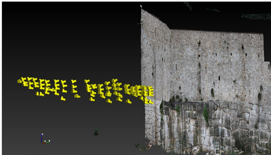
Figura 5.36 - Vista delle posizioni della camera in ciascun fotogramma
