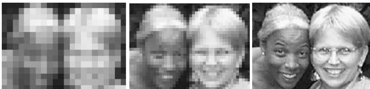
Figura 4.10 - Effetto della densità di campionamento dell'immagine.
