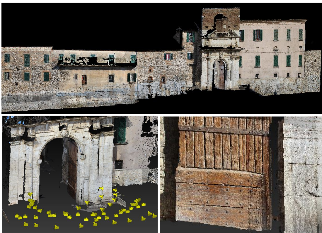
Figura 5.45 - Ricostruzione della zona E e dell'area di Porta Romana e dettagli dei modelli
