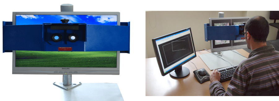
Figura 3.6: Visore che consente la visione stereoscopica anche con monitor LCD
