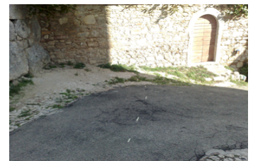
Figura 5.6 - Riferimenti a terra per mantenere uniforme la distanza di presa
