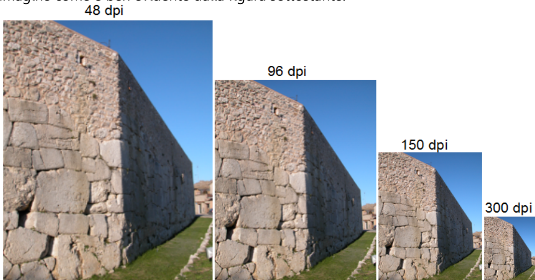
Figura 4.12 - Un'immagine con lo stesso numero di pixel (225x300) appare molto diversa al variare della risoluzione geometrica poiché cambia la dimensione dei pixel.
