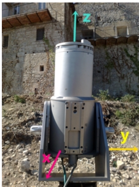
Figura 2.7 - sistema di riferimento solidale allo strumento
