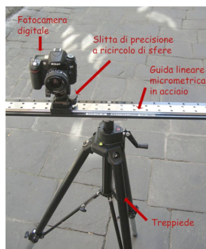
Figura 6.2 - Z-Scan: kit di presa
