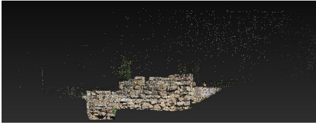
Figura 5.29 - Bundle del blocco di 144 foto. L'area delle mura è estremamente densa.
